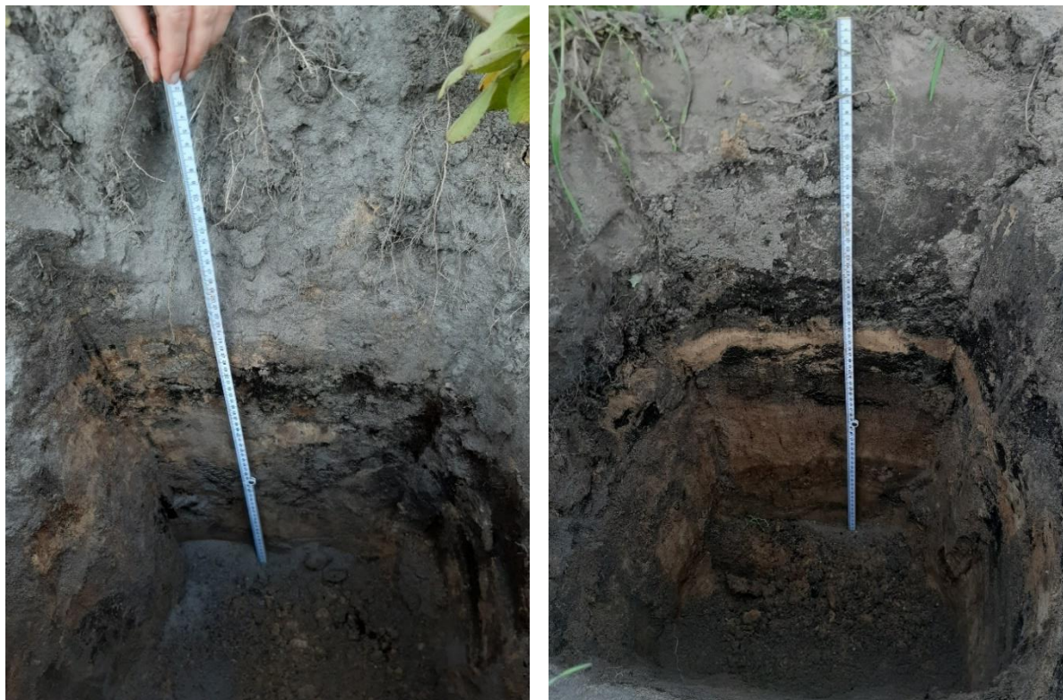
Figuur 4. Links: Profiel van het referentieperceel met aardappel. De veenlaag is meer vermengd met zand, waarschijnlijk door bodembewerkingen. Rechts: Profiel van de bufferstrook aan de oostzijde. Hier is dezelfde gelaagdheid zichtbaar als aan de westzijde (figuur niet getoond) behalve dat de dikke veenlaag hier onderbroken wordt door een dun (paar cm dik) zandlaagje. De zandlaag onderin is iets donkerder (humusrijker).
